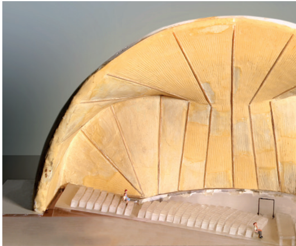
Schnitt durch eine halbe Umstülpungshalle , Modell aus den späten 60er Jahren. Paul Schatz schrieb den Raumformen, die durch den Prozess der Umstülpung entstehen, besondere akustische Eigenschaften zu. Hier als Konzerthalle angedacht.
